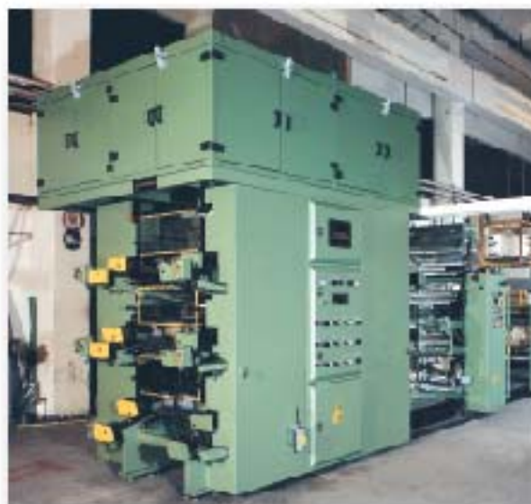
Costruttore di macchine da stampa. Cabina afonica per ventilatori di essiccazione. Printing machine manufacturer. Soundproof cubicle for drying fan.
