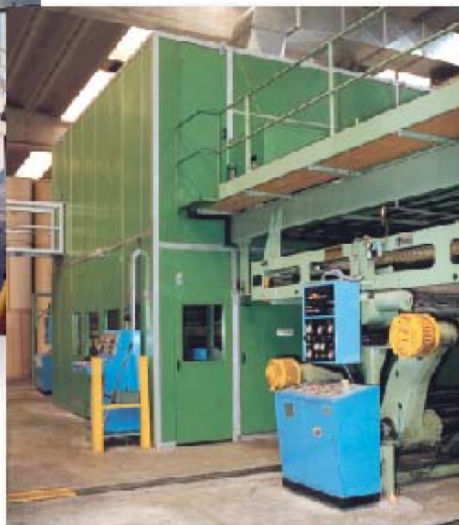
Produzione cartone ondulato. Cabina fonica per onduttore. Production of corrugated board. Soundproof cubicle for corrugating machine.
