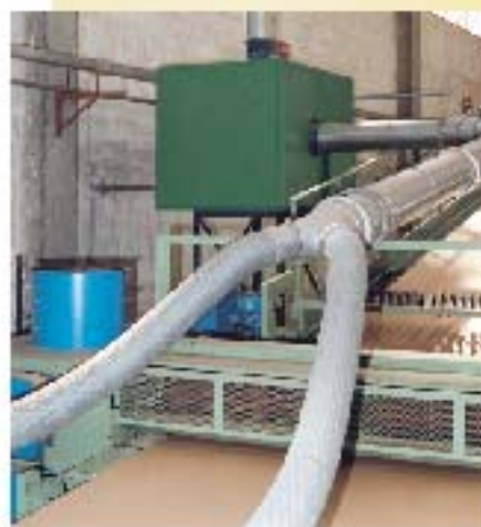
Cartotecnica. Cabina fonica per ventilatore stacciatore. Manufacture of paper and cardboard articles. Soundproof cubicle for rag engine fan.
