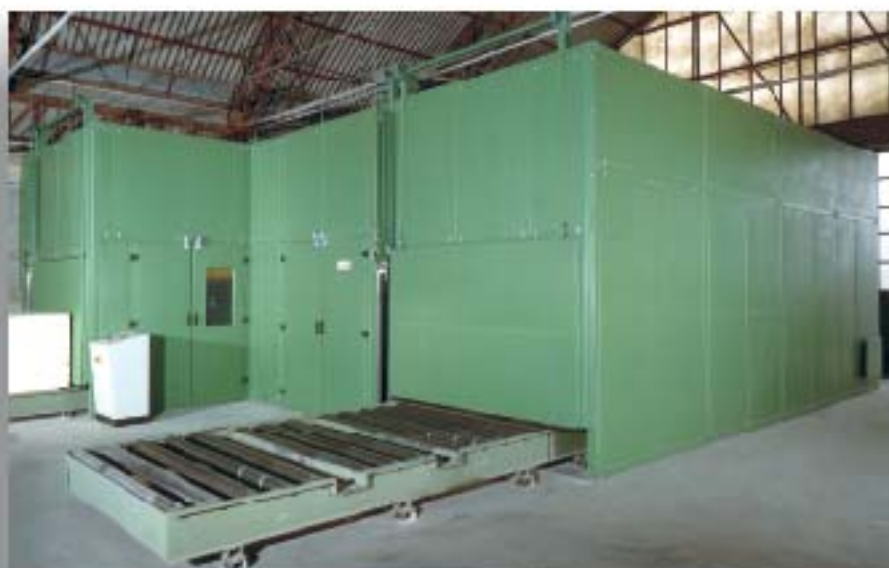
Produzione compensati. Cabina fonica per quadratrice. Plywood production. Soundproof cubicle for framing square.
