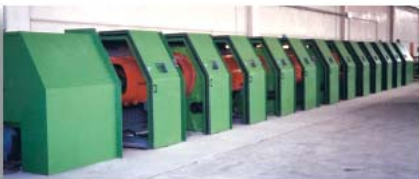
Lavazione del filo. Cabina fonica per cordatrice tubolare. Wire manufacture. Soundproof cubicle for tubular stranding machine.
